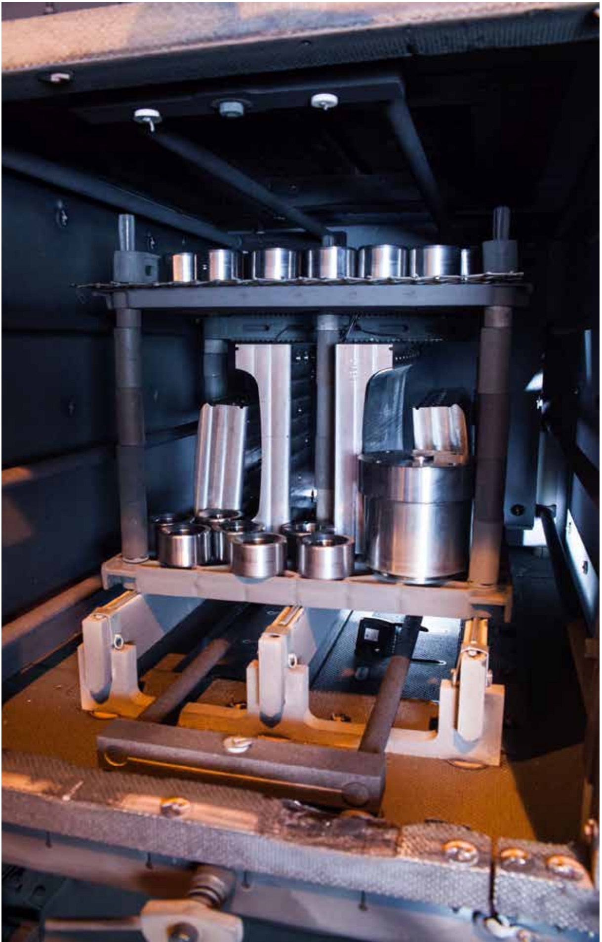
Työkaluteräket vaativat kunnon karkaisun. Muuramen vakuumiuneilla saavutetaan parasta laatua pienillä mittamuutoksilla. Lähes kaikki työkaluteräket sopivat vakuumikarkaisuun. Menetelmiä ovat työkalujen vakuumikarkaisu ja -hiiletys.
