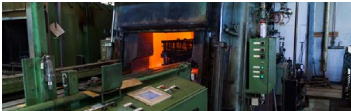
Muuramen karkaisimon Ipsen TQF-10 suojaakaasu-uuni hiiletyskarkaisuun. Uunin hyötykorkeus on 860 mm ja maksimipanos 1000 kg. Prosessitietokone laskee hiiletettäville kappaleille optimaalisen hiiliprofiilin.
